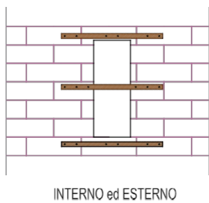
FIGURA 4 Operazione di avvitamento delle tavolette a dx e asx delle aperture
